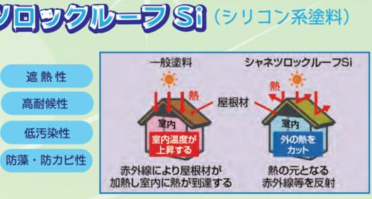
スレート屋根・塗装瓦・トタン屋根におすすめ!!
